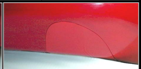
10995 GFK-Blende zum Verschließen des Serienausschnittes in der Stoßstange
