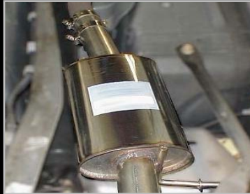
10884 Edelstahlschalldämpfer 2 x 120 x 80 mm oval rechts + links aussen
