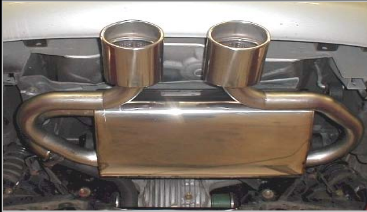
10882 Edelstahlschalldämpfer 2 x 120 x 80 mm oval – mittig für NB-1+2
