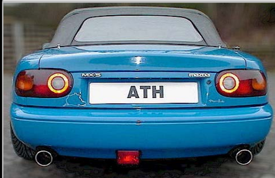
11068 Edelstahlschalldämpfer komplett aus Edelstahl. 2 Endrohre rund 90mm rechts + links. MX-5- NA alle
