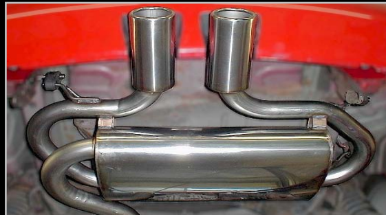
10977 Edelstahlschalldämpfer komplett aus Edelstahl. 2 Endrohre rund 90mm mittig. MX-5- NA alle
