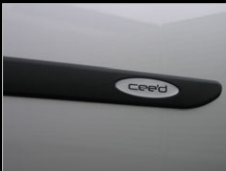
11672 Seitenschutzleisten einfache Montage – wird nur verklebt
